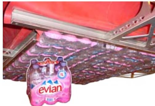
Ganz gleich ob es eine einzige Flasche, eine Reihe, eine komplette Lage ist, ob palettiert oder depalietiert werden soll - dank der auf dem UniGripper basierten Lösung, weist der BottleGripper die gleiche Flexibilität und Möglichkeit wie alle anderen UniGripper auf.
