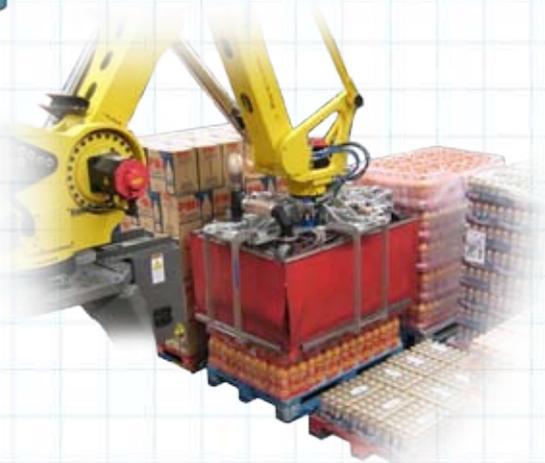
Komplette Lagen zu hantieren, ist keine einfache Aufgabe. Hier spielt der UniGripper-LayerGripper seine technologischen Vorteile voll aus. Der LayerGripper ist in verschiedenen Editionen erhältlich, welche nicht nur den Gegebenheiten des Produktes angepasst sind, sondern auch der Menge verschiedener Produkte und Lagen welche zu hantieren sind.
