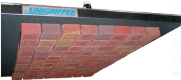
Zu 100% auf jedes Projekt zugeschnitten, werden alle kundenspezifischen UniGripper, nach unserem hohen Standard gebaut. Die einzigartige und patentierte Ventiltechnologie erlaubt es, dem UniGripper zu erkennen, ob und wo sich ein Produkt unter dem Greifer befindet und überträgt nur dort das Vakuum.
