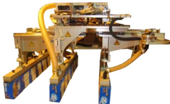
Greifzonen, erlaubt es dem UniGripper eine ganze Reihe von Produkte zu nehmen, und diese dann gesondert abzulegen. Das Zubehör welches im Prinzip, schon am Anfang definiert werden muss, ist die Vakuumzeugung. Ob pneumatische Vakuumzeugung, basierend auf dem Venturiprinzip oder elektrische Seitenkanalverdichter, der UniGripper wird immer mit der besten Vakuumzeugung für die jeweilige Aufgabe konzipiert.
